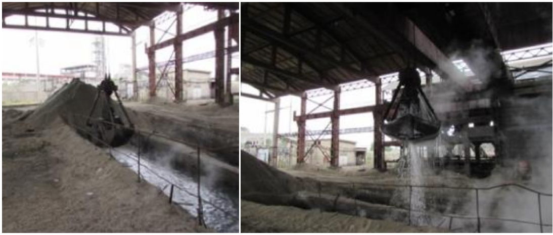
სურ.21.სილიკო-მანგანუმის წარმოებაში სამშენებლო შლაკის მიღება
